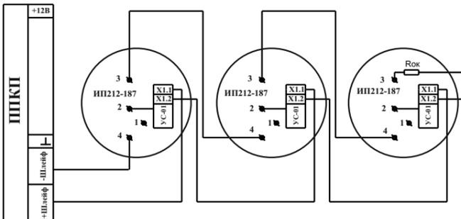
Схема подключения извещателей к приемно-контрольному прибору с использованием дополнительного резистора
