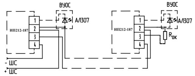
Схема подключения извещателей к двухпроводным шлейфам со знакопеременным напряжением.
