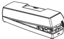
**10** **ДУВ** разместить на полу контактными площадками вниз в **наиболее низком** месте помещения, где необходимо контролировать возможность затопления (с учетом направления стока воды в случае прорыва водопровода или системы отопления)
