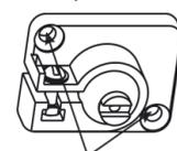
**в)** Совместить выступ основания извещателя с пазом шарика кронштейна и вернуть винт с внутренней стороны основания извещателя в шарик кронштейна.
