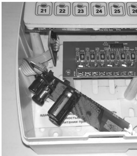
Рис. 3. Установка и подключение модуля SMS
