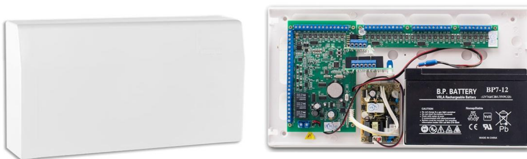
Рис. 1. Системный блок (вид снаружи и внутри)
