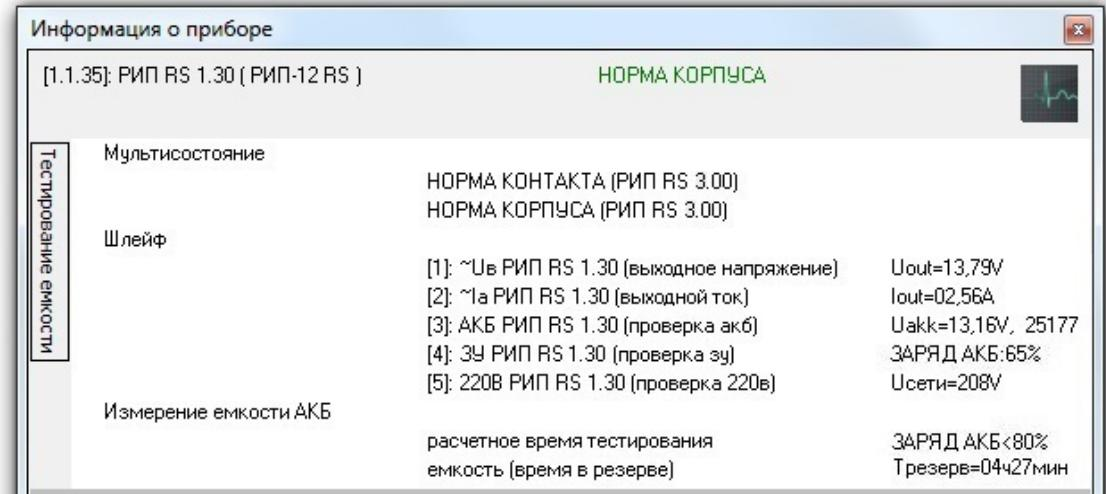
Из данного информационного окна доступно управление тестированием АБ РИП. При нажатии на кнопку «Тестирование емкости», отобразится панель для запуска\остановки тестирования АБ РИП.
