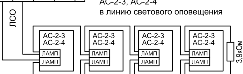
Рис.А5 Схема подключения светового канала «АС-2-3», «АС-2-4» к ЛСО
