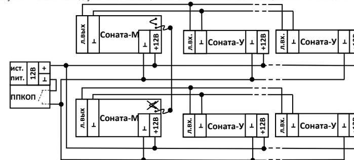
Рисунок – 4 Групповое включение оповещателей СОНАТА-М исп. 2 и «СОНАТА-У исп. 2» с возможностью контроля управляющей и питающей линий с применением БКЛО-12
