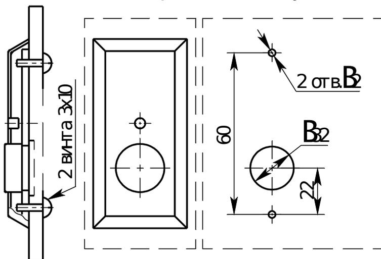
Отверстие диаметром 32 мм и глубиной не менее 2 мм необходимо для исключения замыкания контактов
