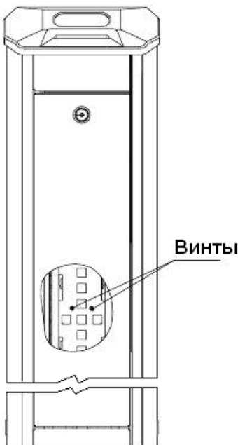
**Рис.2** Расположение крепежных транспортных винтов
