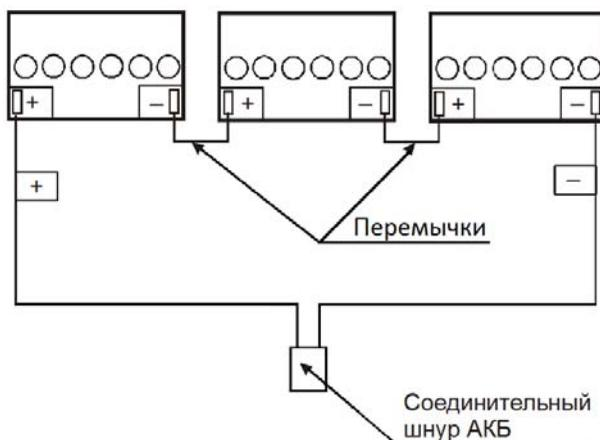
Рисунок 1. Схема соединения аккумуляторов в батарею.
