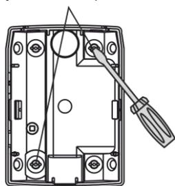
**б)** Сделать разметку монтажных отверстий на выбранном месте по приложенному кронштейну. Закрепить кронштейн
