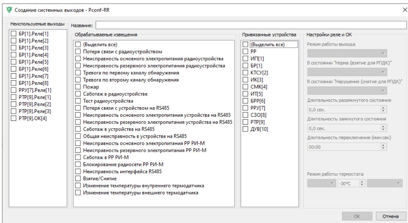
3. **Неиспользуемые выходы.** Выбрать один или несколько свободных физических выходов. Если выбрать несколько выходов, то будут созданы соответствующие выходы с одинаковыми параметрами, которые впоследствии можно отредактировать. Список «Неиспользуемые выходы» состоит из выходов, имеющих во всех зарегистрированных устройствах, и для которых еще не произведены настройки.
