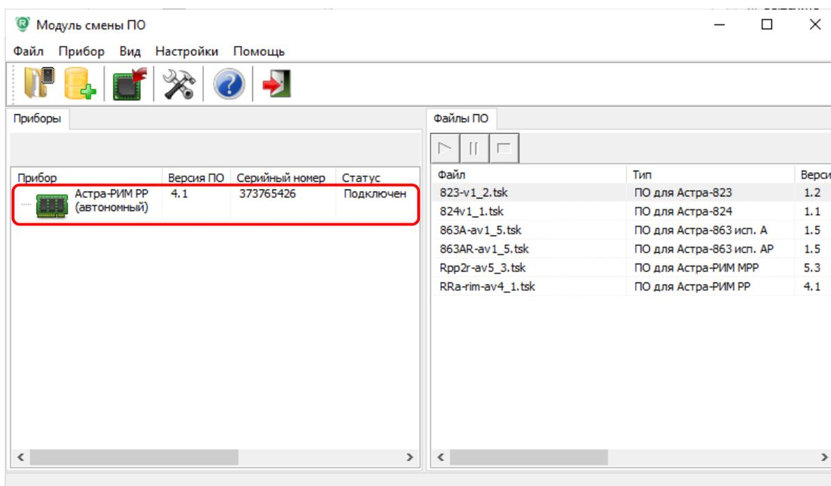
3. - В левом окне Модуля выделить определившийся прибор.
