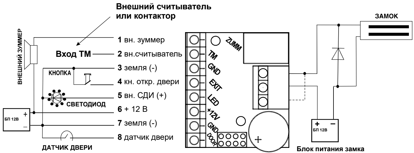
Рис.6 Подключение внешних устройств.
